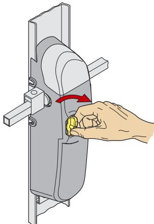
Для разблокировки поверните желтую ручку по часовой стрелке приблизительно на  $120^\circ$ , как показано на рисунке. Учтите, что сразу же после разблокировки возможен наклон ворот.
